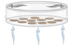
【 ポリスチレン / ガラス 】 フタをしたままの状態では培地気液界面からしかガス交換ができない
